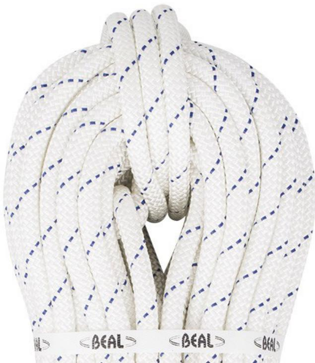
Cuerda tipo A fabricada en Nylon para trabajos en altura y abrasión, su resistencia cumple con la normatividad de línea de vida ya que resiste las 4.400 Libras 44 KN y permite el adaptamiento versátil a cualquier usuario. De excelente calidad que garantiza la seguridad y comodidad. Certificación CE EN 1891.
