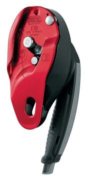
Descendedor autofrenante con función antipánico para el rescate técnico, provisto de una empuñadura multifunción que permite controlar la velocidad de descenso, desplazarse con fluidez por un plano inclinado u horizontal y posicionarse en el puesto de trabajo sin llave de bloqueo. Descenso de cargas pesadas hasta 272 kg. Función antipánico que se activa si el usuario tira demasiado fuerte de la empuñadura: frena y detiene automáticamente el descenso.
