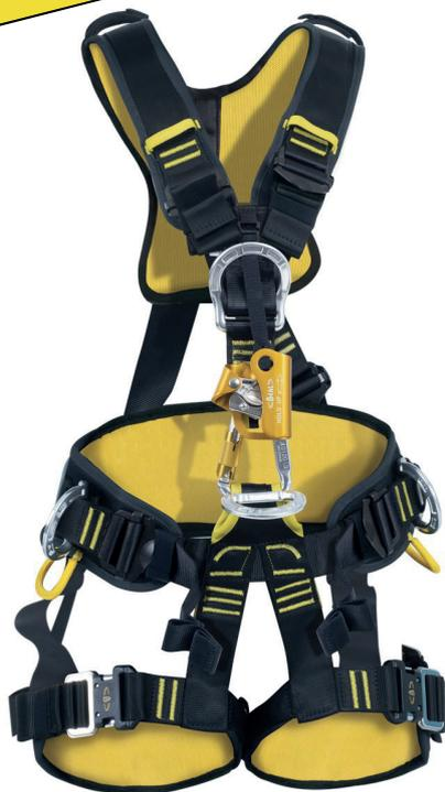
Arnés de suspensión, anticaídas y de sujeción que facilita el ascenso mediante cuerda. Equipado con un bloqueador ventral HOLD-UP adaptado a los ascensos mediante cuerda. El HOLD-UP, permanece perfectamente paralelo al cuerpo del usuario proporcionando un deslizamiento fluido de la cuerda y el máximo confort. Queda situado muy bajo para permitir la mayor amplitud de movimientos.
