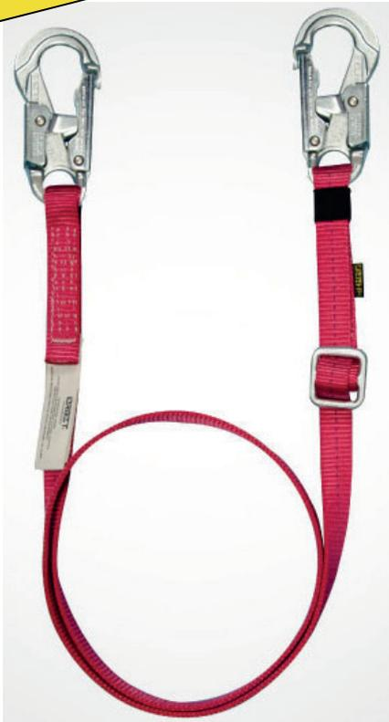
Eslinga de posición graduable en reata, se usa para trabajos apoyado sobre las piernas, posibilidad de tener las manos libres, posee una hebilla de regulación en acero que permite ampliar o reducir la distancia de 1.20 a 1.80 metros, la eslinga cuenta con dos ganchos de 20 mm de apertura, carga tensil 40 kN.
